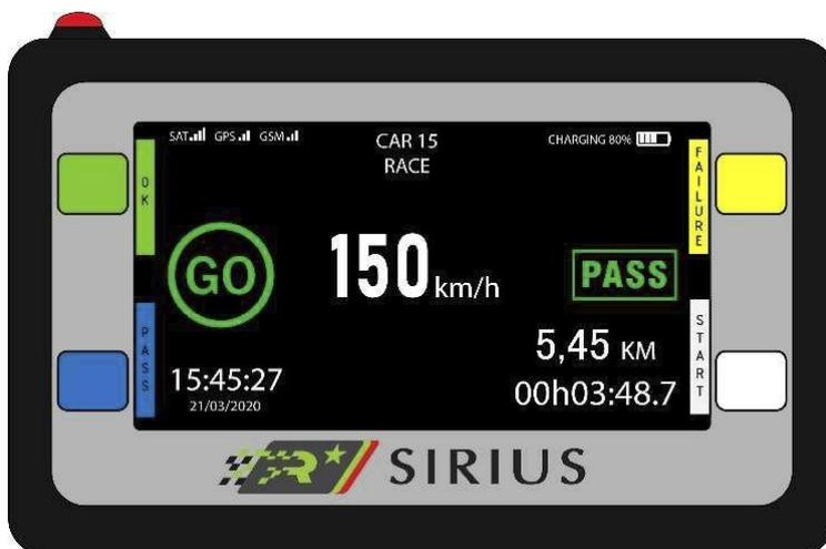
**Dicho sistema funciona a través de la antena X-bee y tiene un alcance en condiciones ideales de aproximadamente 300 metros en línea vista, siempre respetando la instalación según se indica en el manual de instalación.**
