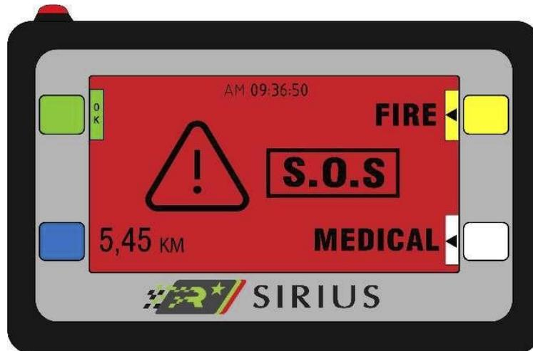
El Sistema de alertas del dispositivo SIRIUS, cuenta con retransmisión inalámbrica vehículo a vehículo sin necesidad de ningún tipo de conexión celular ni satelital, de esta manera conseguimos poder proveer colisiones en tramo marcando dónde y cuándo nos vamos a encontrar con un vehículo detenido. Dicho sistema funciona a través de la antena X-bee y tiene un alcance en condiciones ideales de aproximadamente 300 metros en línea vista.
